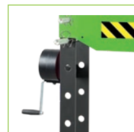
ARGANO A FUNE PER REGOLARE ALTEZZA PIANO DI LAVORO
